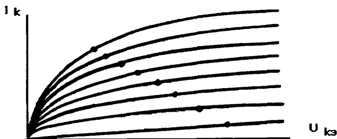
Рис.2 Динамическая характеристика транзистора на экране осциллографа обозначается восемью точками на семействе выходных характеристик.
